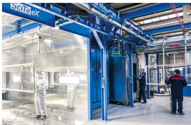
⬆ Linia do malowania proszkowego według koncepcji RUBICOAT®.
